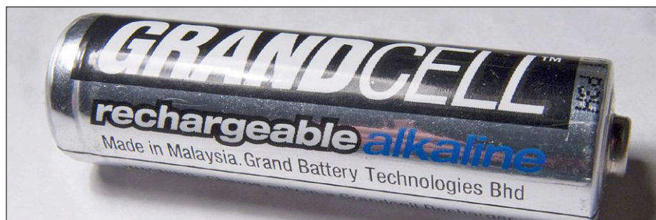
Figuur 7. Alkali/mangaan RAM-accu in de typische AA-behuizing. Dergelijke batterijen mogen nooit diep worden ontladen en hebben een speciale lader nodig.
